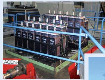
POWER PLANT RACKS SHAKING TEST
